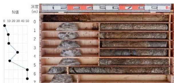
図-2 基盤岩のボーリングコアの1例 (ボーリング No.2-4)
