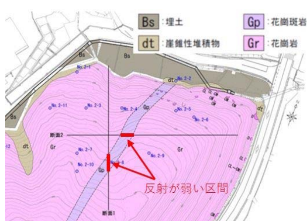
図-6 探査結果を反映した地質平面図
