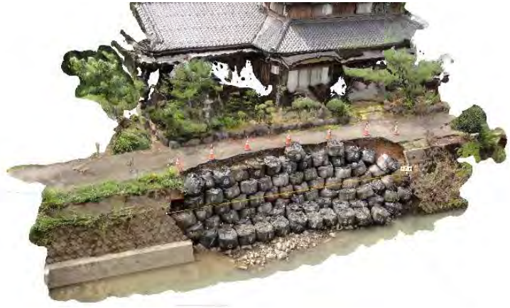
写真-8 現地踏査の写真から生成した 3D モデル
