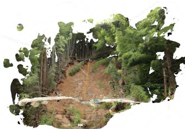
写真-12 現地踏査の写真から作成した 3D モデル
