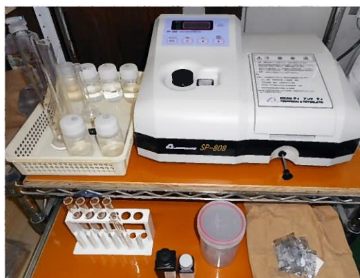
写真-1 (左) 六価クロム溶出量の定量化機器と測定状況 写真-2 (右) 専用試薬による六価クロム溶液の発色状況
