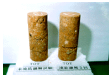
写真2 砂質の土 TOT処理
