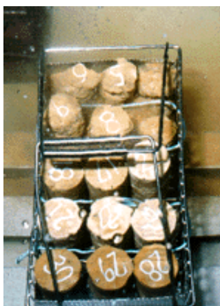
写真1 水浸直後の様子 無処理（上の6つ）は崩壊し始めている。 TOT処理（中の6つ）は変化なし。
