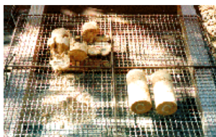
写真2 野外放置後42日目（8月11日） ：完全に流失 ：破損し外側は残存したがTOTの浸透しない内部は一部流失した ：変化なし
